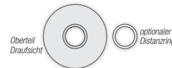
Das Oberteil muss zentriert und flach auf dem Getriebeteller sitzen. Abhängig vom Durchmesser des Getriebebolzens eine Druckscheibe wählen:
