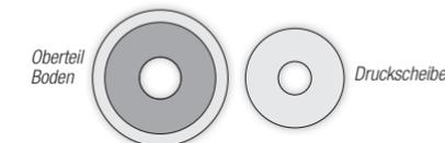
Die gewählte Druckscheibe auf den Getriebebolzen schieben, bis diese auf dem Bürstenkopf-Oberteil aufliegt.
