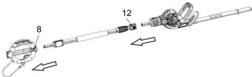
Zum Einstellen der Länge des Teleskopstiels, drehen Sie die Überwurfmutter gegen den Uhrzeigersinn und ziehen Sie den Stiel bis zur gewünschten Länge aus. Ziehen Sie danach die Überwurfmutter handfest an.
