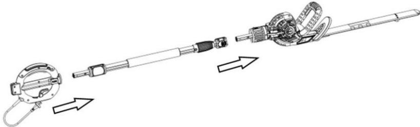
Zum Entriegeln und Abnehmen des Handgriffs aus der Motoreinheit, drücken und halten Sie beide Entriegelungsknöpfe PUSH am Handgriff (8) gedrückt und ziehen Sie den Handgriff heraus. Zum Entriegeln und Abnehmen des Teleskopstiels aus der Motoreinheit, drücken und halten Sie beide Entriegelungsknöpfe (12) und ziehen Sie den Teleskopstiel heraus.
