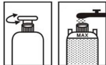
2. Füllen Sie die Chemikalie am besten mit einem Messbecher in den Behälter und geben Sie die notwendige Menge Wasser hinzu. Gehen Sie beim Einfüllen und Mischen von Chemikalien vorsichtig vor und überfüllen Sie nicht den Behälter. Das Fassungsvermögen beträgt max. 5 Liter.
