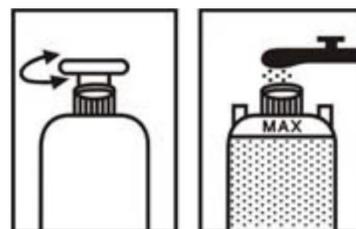
2. Meng de concentraten in een aparte maatbeker voordat u ze in de tank vult. Voeg de benodigde hoeveelheid water toe en zorg ervoor dat de tank niet te vol is. Wees voorzichtig bij het mengen, gieten en hanteren van chemicaliën. De tankinhoud is 5 liter.
