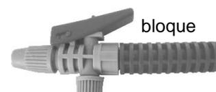
Appuyez d'abord sur le bouton, puis poussez-le vers l'avant jusqu'à l'extrémité pour le verrouiller en place. Le bouton-poussoir est alors verrouillé et vous n'avez plus besoin de le tenir pour pulvériser.
