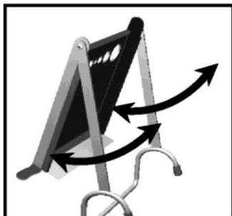
Die Gelenkschrauben müssen so stark angezogen sein, dass beim Ausklappen der Materialablage ein Widerstand zu spüren ist.
