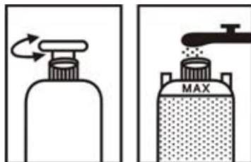
2. Füllen Sie die Chemikalie am besten mit einem Messbecher in den Behälter und geben Sie die notwendige Menge Wasser hinzu. Gehen Sie beim Einfüllen und Mischen von Chemikalien vorsichtig vor und überfüllen Sie nicht den Behälter. Das Fassungsvermögen beträgt max. 5 Liter.
