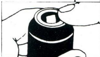
5. Drücken Sie den Mittelteil zurück um Zugang zum Bit zu erlangen.
