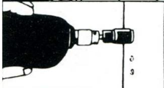
4. Arbeiten Sie mit gleichmäßigem Druck bis die Schraube eingedreht ist.
